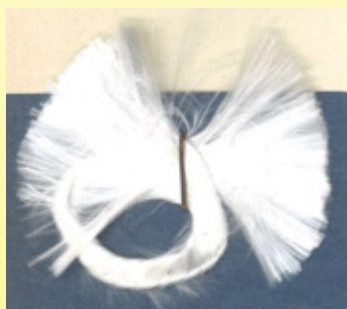
Haces de filamentos de vidrio formando un solo cable (Fabricación de filamento de vidrio, alrededor de 1960, lección de la escuela textil de Verviers en Bélgica, Museo Ultiheat)
